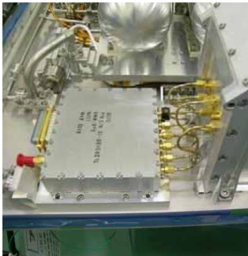
サブミリ波局部発振器 制御部(SLOC)
